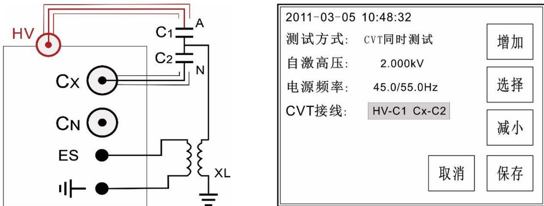
(3)、不拆高压引线测试 CVT 电容值和介损测量模式：CVT 自激法。电压 $\leq 2\text{kV}$
