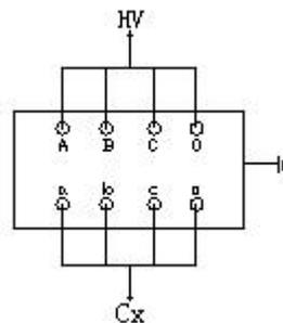
图 6-9 变压器接法
