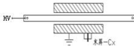
图 6-7 套管接法
