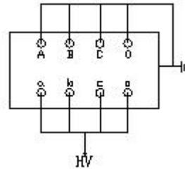
图 6-11 变压器接法
