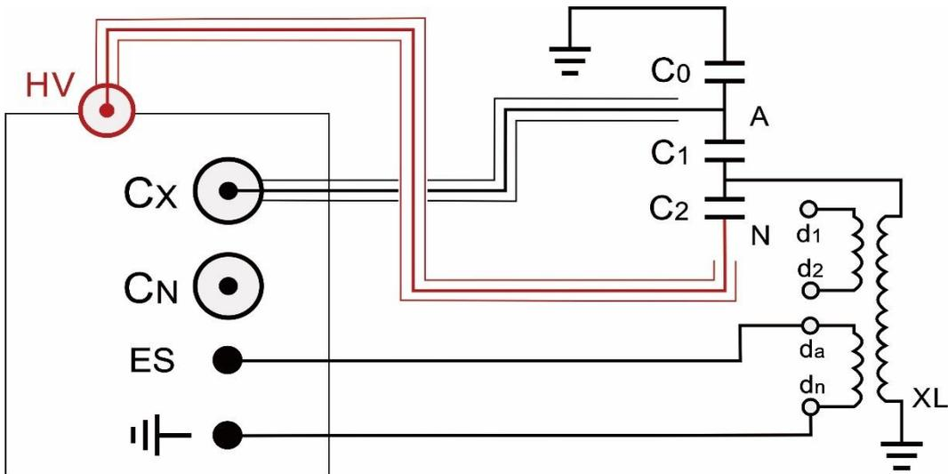
(4)、反接屏蔽法测量 CVT 上端 C0 的电容值和介损测量模式：反接法。电压 $\leq 2\text{kV}$
